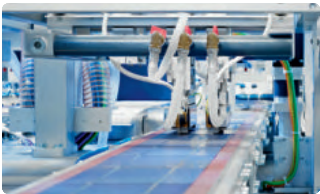
Das Herzstück in unserer Modulproduktion ist der sogenannte „Stringer“. Hier werden die Solarzellen vollautomatisch in Reihe verlötet.
