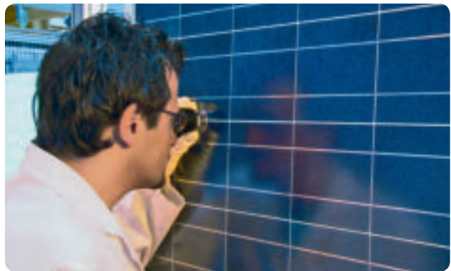
Abschließend wird jedes Modul an der Visitierstation detailgenau geprüft.
